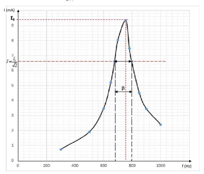
**4.2.2.** Graphiquement fo est obtenue pour I maximale ( $I_0 \approx 9,35 \text{ mA}$ ) :  $f_0 \approx 755 \text{ Hz}$
